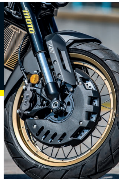
Πίσω από το ιδιόρρυθμο σχεδιαστικά πλαστικό κάλυμμα βρίσκεται το νέο και πολύ ισχυρότερο φρένο της J.Juan
